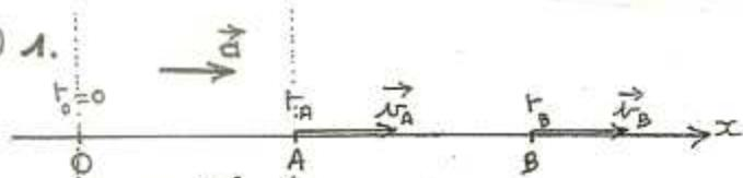
le mobile va de 0 à A d'un mouvement uniformément accéléré ( $a = 1 \text{ m.s}^{-2}$ )
