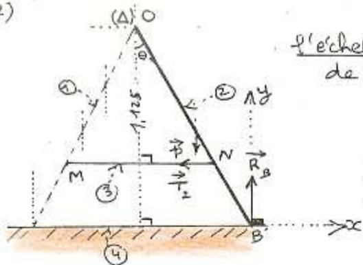
l'échelle simple OB est en équilibre sous l'action de  $\vec{P}$ ,  $\vec{R}_B$ ,  $\vec{T}_2$  et  $\vec{F}_2$
