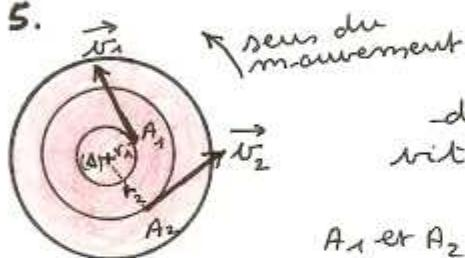
les points  $A_1$  et  $A_2$  décrivent des cercles de centre  $O$ , de rayons  $r_1$  et  $r_2$  ... à une vitesse angulaire  $\omega$  constante (celle du disque)
