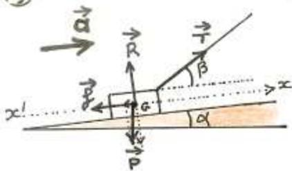
Dans le repère terrestre le centre d'inertie du « système » traineau - a un mouvement rectiligne uniforme varie'
