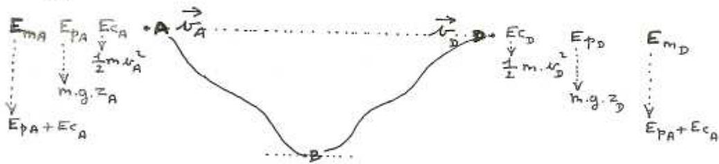
$$\bullet \quad \vec{w}_R = 0 \quad (\vec{R} \text{ est orthogonale à la piste})$$
